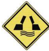
2-33 สะพานเปิดได้
